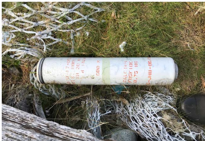
Røykmarkør som inneholder kalsiumfosfid. Lengde: 45–55 cm
